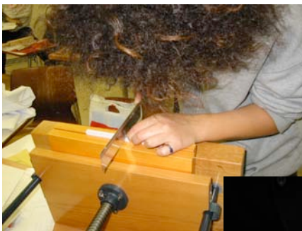
写真2（左上）製本用プレス機に折丁を重ねて固定し、背にかがりのための切り込みを入れる
